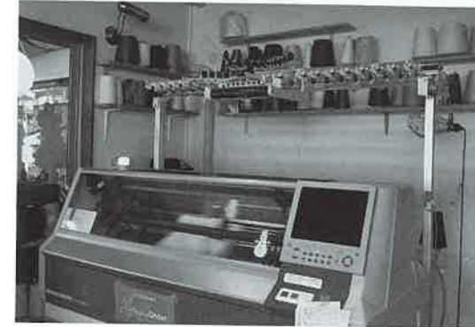
写真2 さまざまな試作・製品を生み出す島精機製作所のホールガーメント編み機
